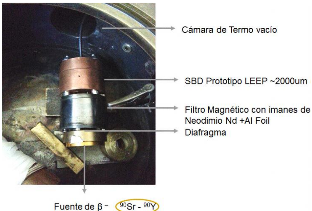
Figura 4.16 - Montaje experimental para prueba del filtro magnético prototipo del detector PT, con fuente de electrones incidentes con energías entre 0 y 2,3 MeV.
